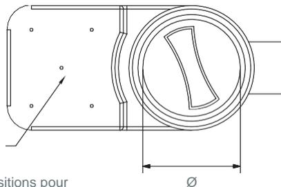
Prédispositions pour perçage tuyau d'entrée
