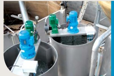
Préparation de flocculant et coagulant
