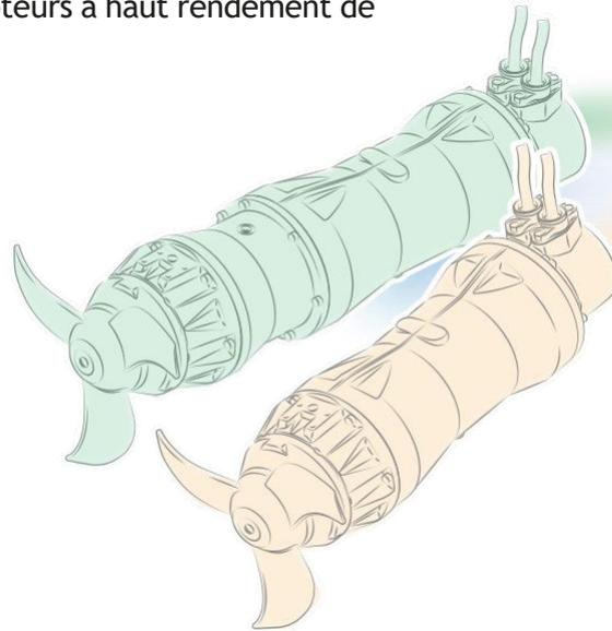
Un solide réducteur épicycloïdal a été privilégié au moteur à grand nombre de pôles pour optimiser la fiabilité mécanique, lorsque l'hélice doit tourner à bas régime dans les applications avec boues à forte concentration de corps solides.
